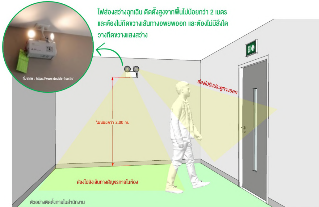
ภาพที่ 4 -19 ตัวอย่างการติดตั้งโคมไฟส่องสว่างฉุกเฉิน
